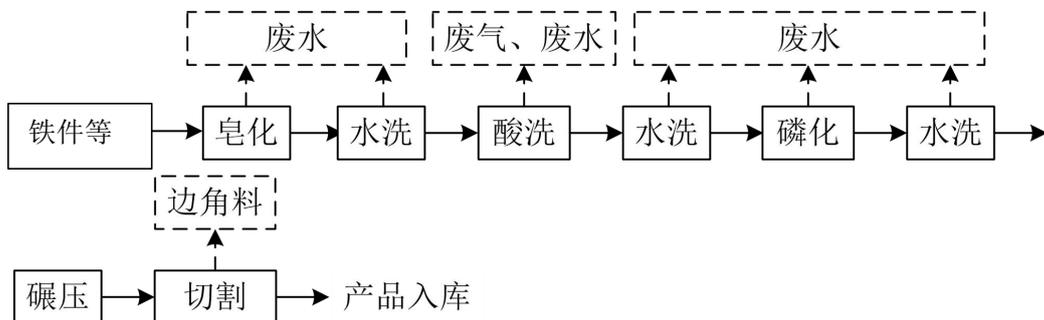
图 3.1-3 拉杆生产工艺流程图
