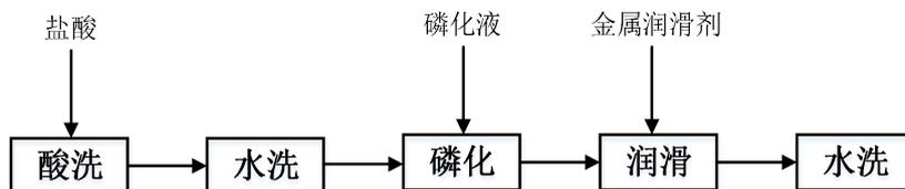
图 3.3-7 酸洗磷化线生产工艺流程图
