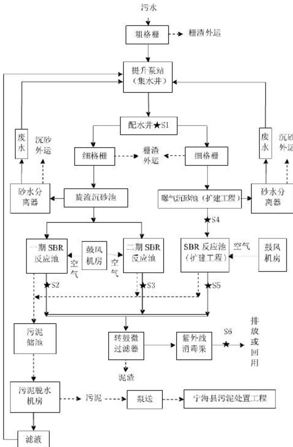
图 4.2-1 宁海县城北污水处理厂现状处理工艺流程
