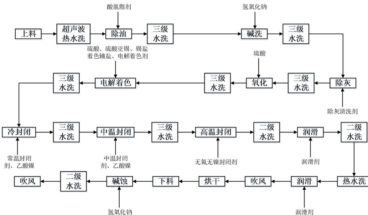
图 3.3-5 氧化线生产工艺流程图
