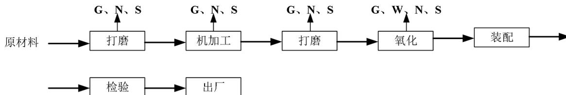
图 3.3-3 天窗导轨生产工艺流程图
