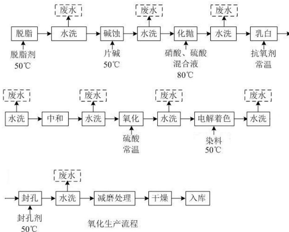
图 3.1-2 氧化工艺流程图
