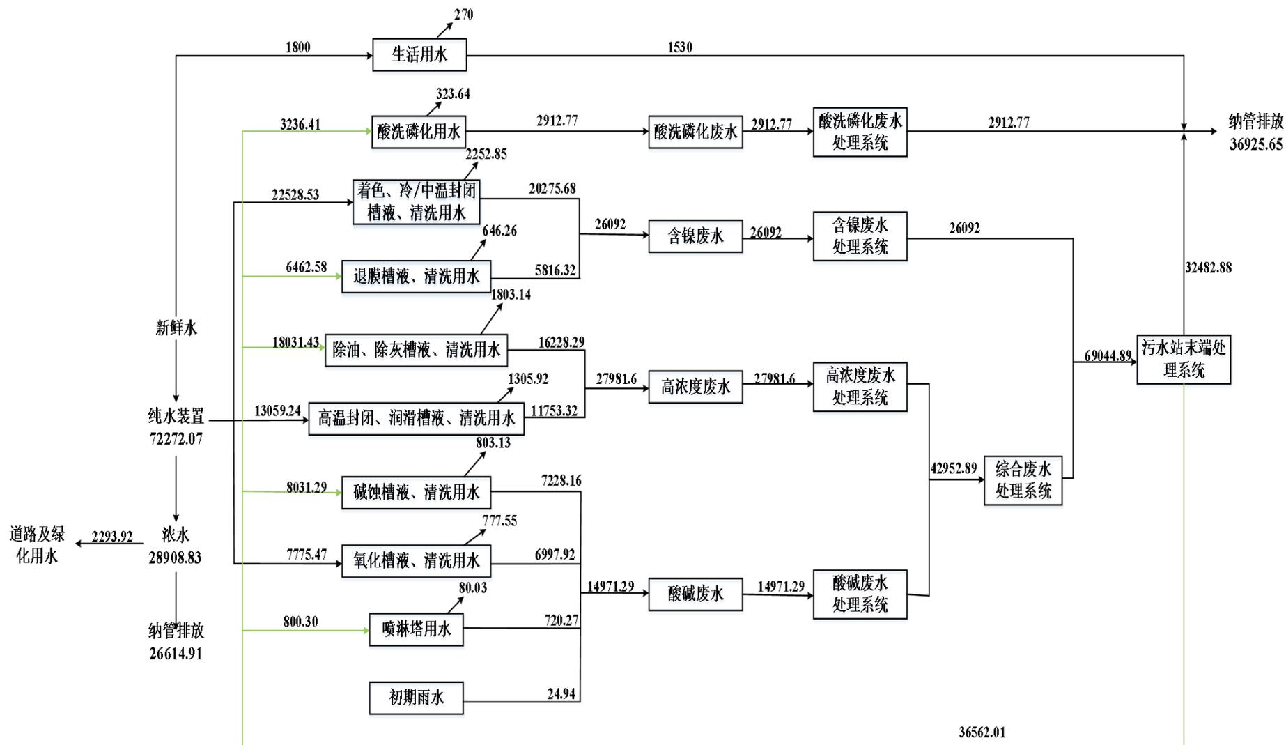
图 3.3-9 水平衡图 (单位: t/a)
