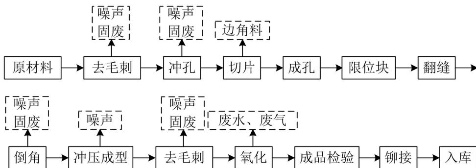
图 3.1-1 天窗导轨生产工艺流程图
